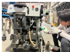
■道路カッター機械メンテナンス
