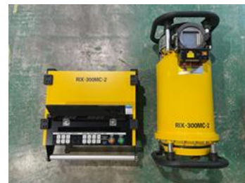
■大型X線検査機「RIX-300MC」。350mm程度の厚い躯体でも検査可能。
