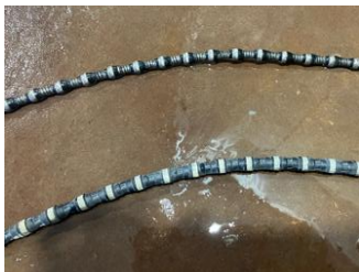
■切断し摩耗したワイヤーと新品のワイヤー。鉄を切断する為ワイヤーの摩耗は激しく如何に熱だれを起こさないかが重要
