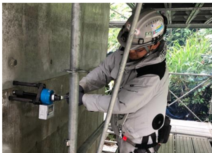
■足場上にて壁面のアンカーを1種資格者にて試験中、報告書も作成します
