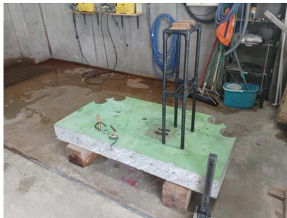
コンクリート躯体を準備し、実際に非破壊検査とコア施工を行う
