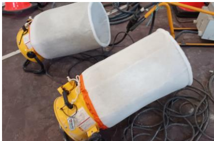
■集塵フィルターにより現場の空気を更に清浄化
