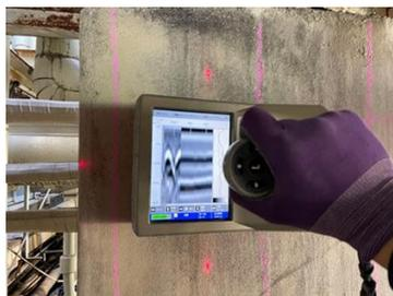
◆鉄筋レーダ探査による鉄筋位置の確認中。
