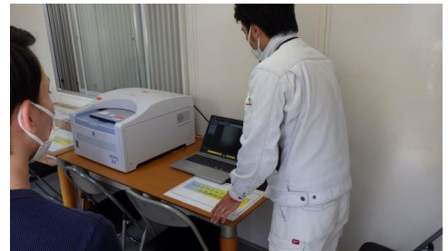
■専用フィルムを専用スキャナーに差込みデータを取り込む
