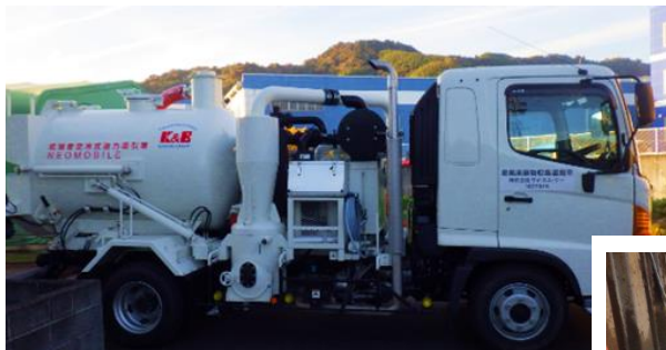
■最大積載量2.3tの吸引車
