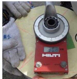
■コンクリートの引張試験 30.8kN計測。
