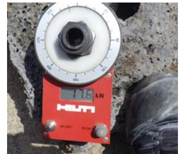
■溶岩の引張試験 17.6kN計測。
