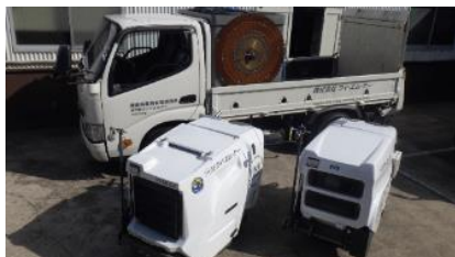
■エンジン式カッター(左)と電気式カッター(右)。大きさはほぼ同じ
