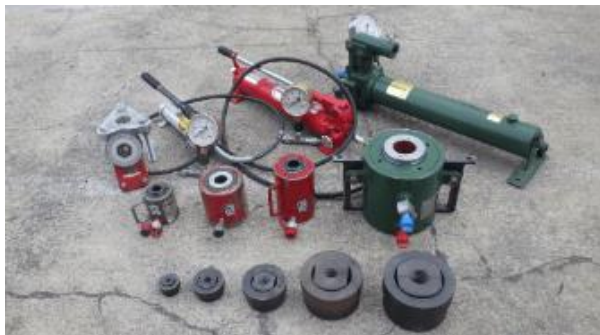
■ワイ・エム・ケーの引張試験機。D10~D51まで、全タイプの引張試験に対応できるラインナップ。
